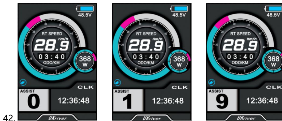
43. The screen display of the PAS level adjust (pantalla de ajuste de nivel de PAS)
